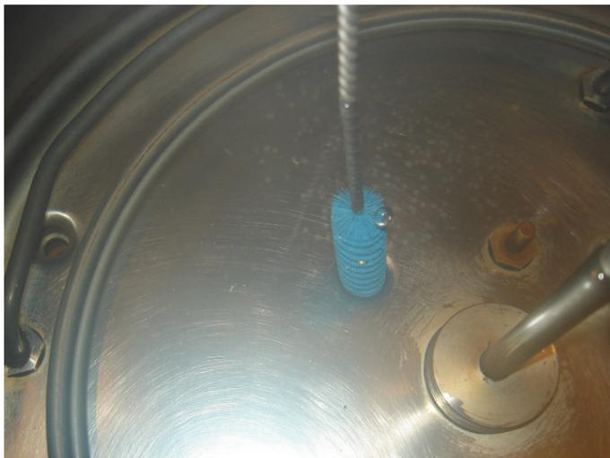
Lors du nettoyage du fond de la cuve, nettoyer également les orifices des circuits de pression et d'aspiration.
