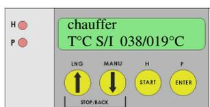
La pompe et le corps de chauffe restent activés jusqu'à ce que la température d'empâtage programmée soit atteinte. Les températures théorique et réelle s'affichent à l'écran.
