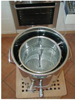
Une fois la température d'empâtage atteinte, un signal sonore retentit. Validez avec ENTER. A présent, mettez le tuyau de malt en place (joint installé vers le bas). Veillez à ce que le joint soit centré sur le tuyau de malt et repose bien à plat dans le fond de la cuve. Enfoncez le plateau perforé jusqu'en bas (tuyau vers le haut). Installez ensuite le tissu filtrant (posez le bas au fond de l'eau).
