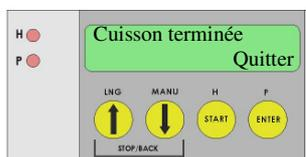
Lorsque le temps d'ébullition s'est écoulé, un signal sonore indiquant la fin du processus de brassage retentit à nouveau. Validez avec ENTER. Le corps de chauffe se désactive.
