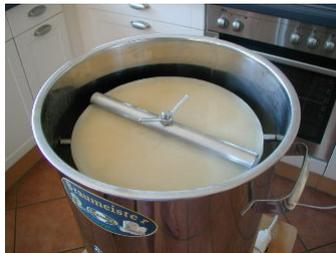
Appuyez sur START pour passer en mode AUTOMATIQUE. L'eau de brassage légèrement colorée monte et déborde. Le circuit a commencé. Les phases de brassage suivantes sont exécutées entièrement automatiquement conformément au programme. Pendant certaines phases de brassage, la commande déclenche une courte pause pour repositionner le malt. L'écran affiche les températures réelle et théorique ainsi que le temps restant à s'écouler une fois le temps théorique atteint (clignotant).
